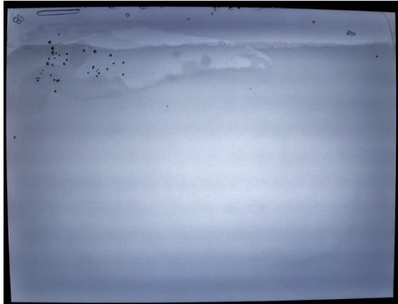
Darstellung eines optical bonded Touch-Systems mit extremen Fehlern – zur Verdeutlichung der auftretenden Herausforderungen und Probleme, speziell bei großen Diagonalen.
